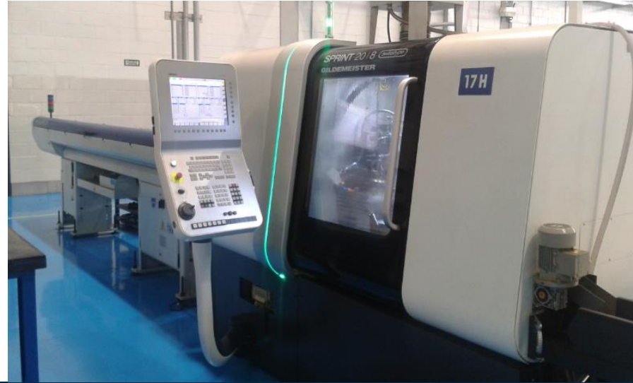
Torno swisstype DMG Sprint modelo 20/8
